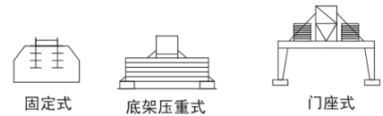
固定式 底座压重式 门座式 Stationary Under frame Loading portal type *可变换的其它安装方式同我们协商 Mounting possibilities Consult us
